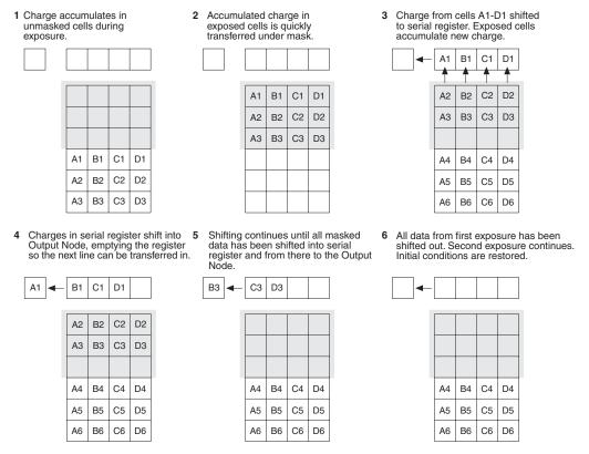
Figure 30. Frame Transfer Readout
